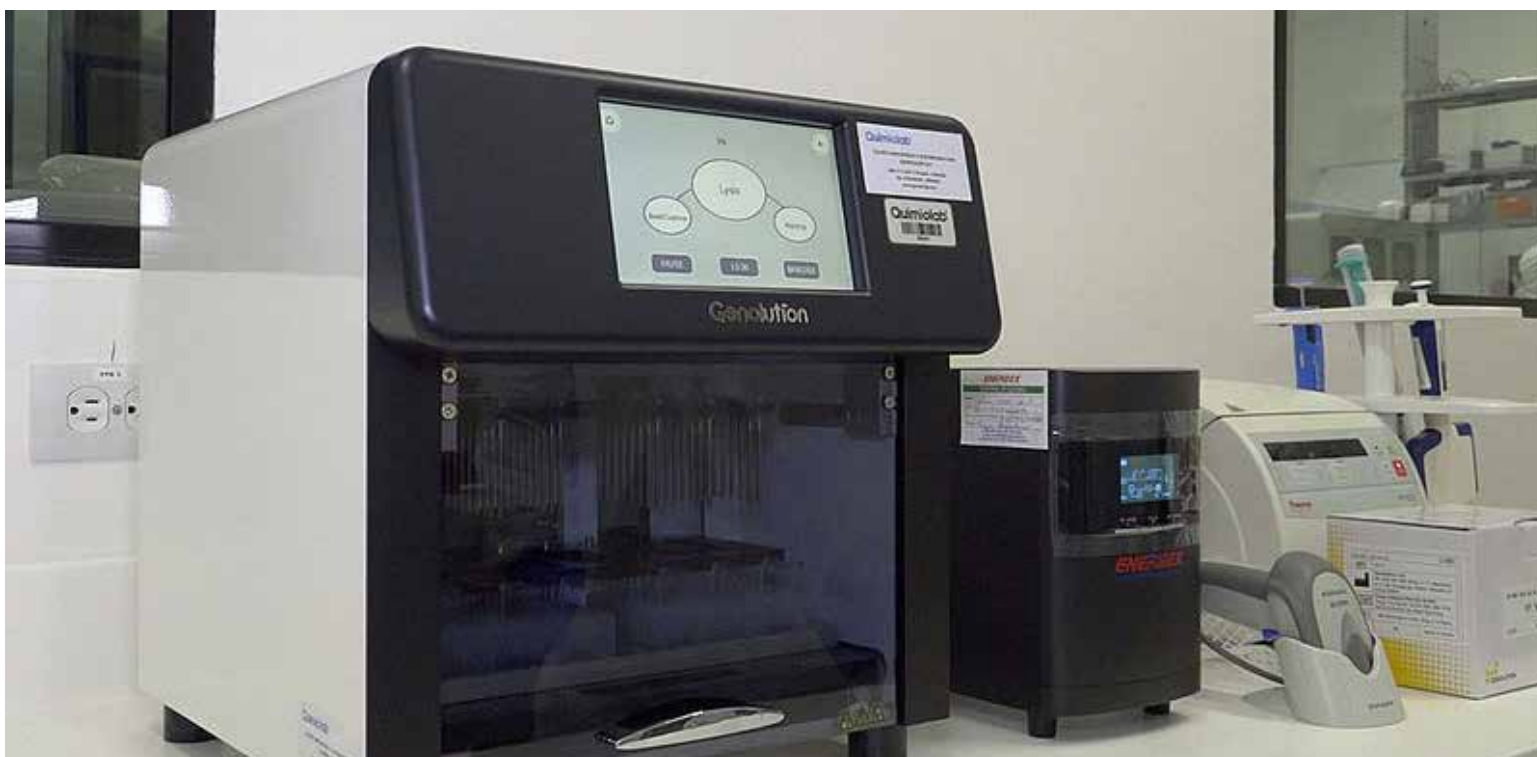
Con el nuevo robot la extracción se reduce a una hora en la que se procesan 96 muestras, lo que hace que el laboratorio triplique o cuadruplique el diagnóstico, según el estado de la muestra.
